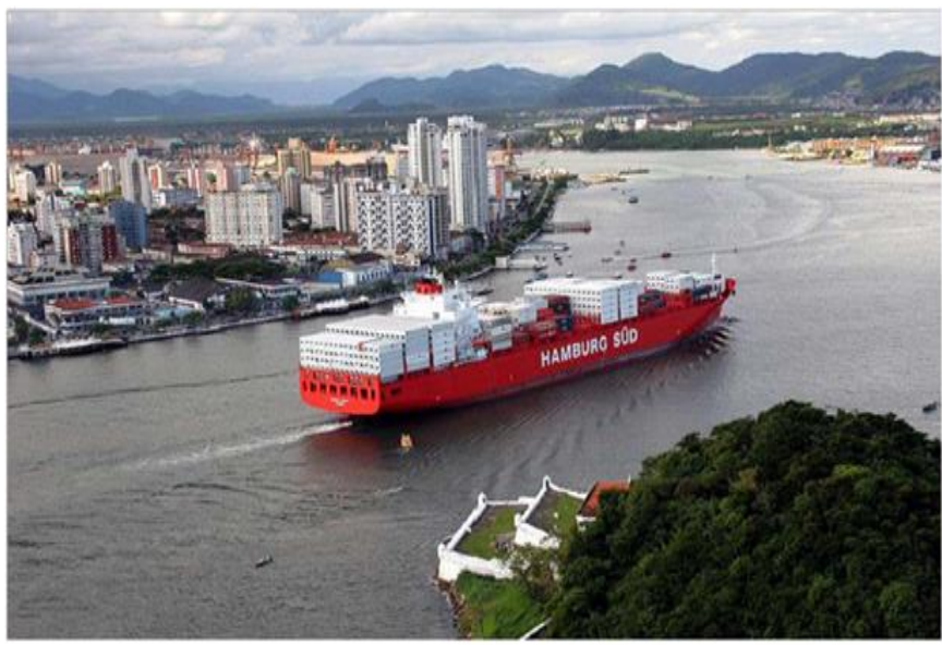
N/M Monte Rosa Comprimento 272m • Boca 40m • Calado 12,5m Capacidade 6.290 TEU • TPB 64.700 • Velocidade de cruzeiro 24 Nós
