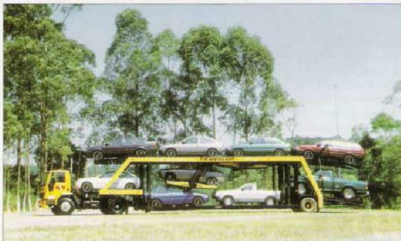
O semi-reboque "Nova Era" foi desenvolvido pela Translor para transportar veículos
